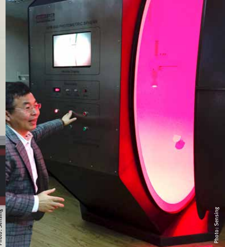
M. Mou montre une sphère photométrique, conçue pour mesurer l'efficacité lumineuse et le rendu des couleurs des sources d'éclairage.
